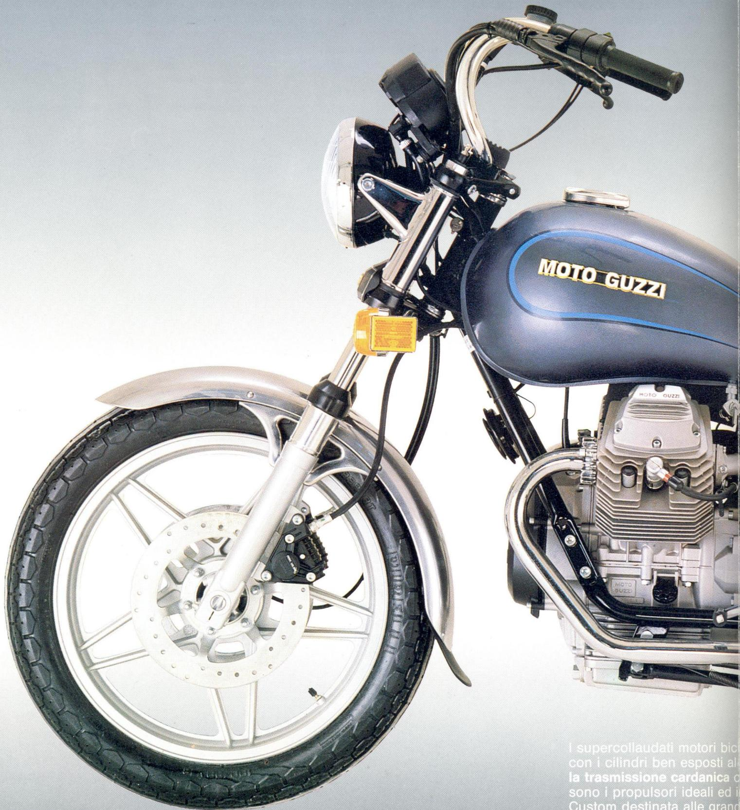
I supercollaudati motori bicilindrici con i cilindri ben esposti alla ventilazione forata e la trasmissione cardanica sono i propulsori ideali ed ideati per la Custom destinata alle grandi
