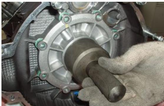
**Attrezzatura specifica****19.92.71.00 Attrezzo montaggio anello di tenuta sulla flangia lato volano**
