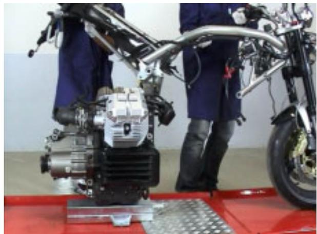
**5.1.2. INSTALLAZIONE DEL MOTORE SUL TELAIO**
