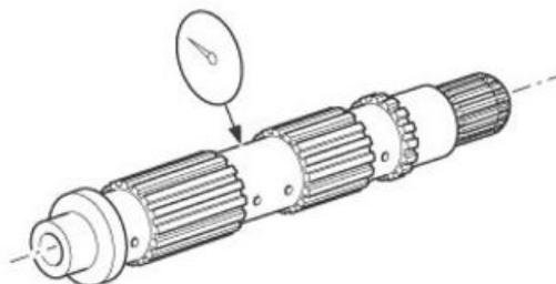
Controllare la presenza di vaiolature e usura sugli ingranaggi della trasmissione ed eventualmente sostituire gli ingranaggi difettosi.
