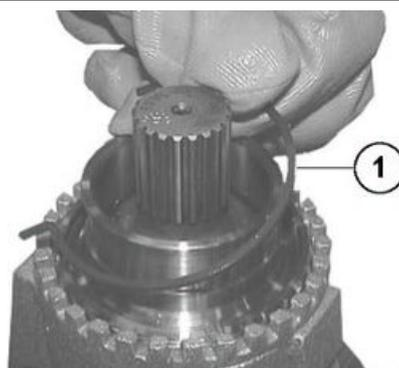
Posizione di assemblaggio dell'anello d'arresto (1).
