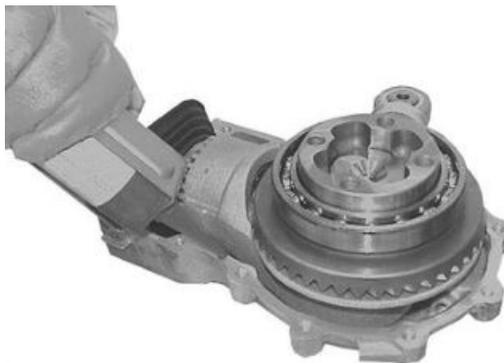
Montare un nuovo anello di tenuta utilizzando il tampone.
