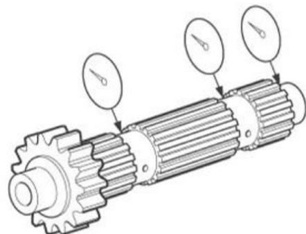
Controllare la presenza di vaiolature e usura sugli ingranaggi della trasmissione ed eventualmente sostituire gli ingranaggi difettosi.
