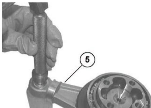
Montare nel supporto (5) l'anello d'arresto (3) con una pinza adatta.
