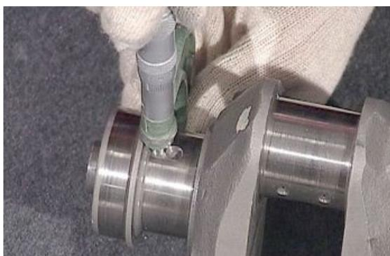
Massimo scarto nel parallelismo dei due assi dell'albero motore (perno di biella e perni di banco lato volano e lato distribuzione) non deve superare mm 0,02 (in 0.0009), alla distanza di mm 40 (in 1.5748).
