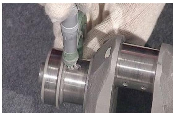
Massimo scarto nel parallelismo dei due assi dell'albero motore (perno di biella e perni di banco lato volano e lato distribuzione) non deve superare mm 0,02 (in 0.0009), alla distanza di mm 40 (in 1.5748).
