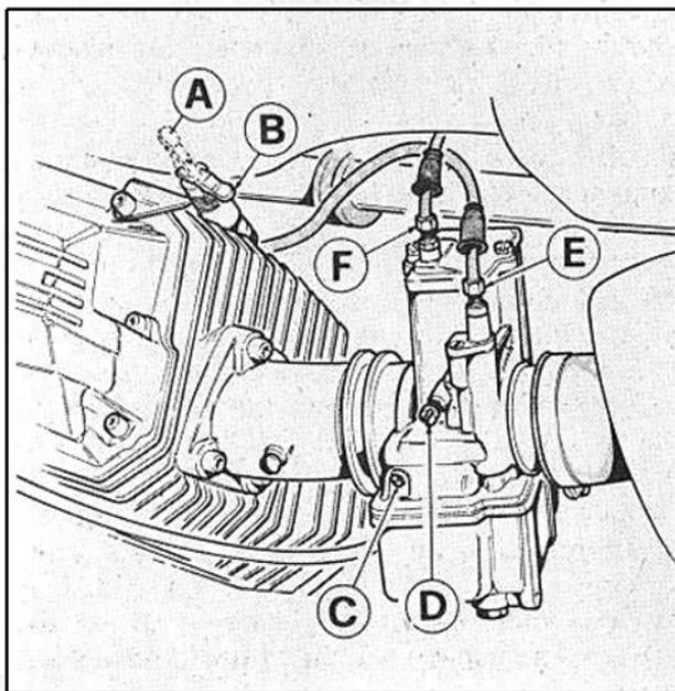
**1** Controllare che con la levetta in posizione di marcia «B», tra i capicorda delle guaine comando «starter» e le viti tendifilo «E» su entrambi i carburatori vi sia un giuoco di mm 3 circa.
