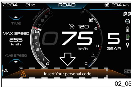
Il cruscotto è dotato di sistema immobilizer che impedisce l'avviamento nel caso in cui il sistema non identifichi una chiave che sia stata precedentemente memorizzata.
