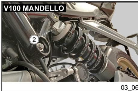
Sulla parte superiore dell'ammortizzatore, solo per "V100 Mandello", è presente un registro (2) per la regolazione della frenatura idraulica in estensione. Le regolazioni dell'ammortizzatore su "V100 Mandello S", invece, avvengono elettronicamente ed è possibile intervenire su tali settaggi tramite il cruscotto. Per maggiori informazioni consultare il paragrafo "FUNZIONI AVANZATE" del capitolo "VEICOLO".
