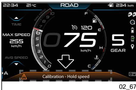
Per calibrare il sistema MGCT (Moto Guzzi Controllo Trazione), percorrere per circa 10 secondi un tratto di strada piano e rettilineo, in seconda marcia alla velocità di 30 +/- 2 km/h (18.64 +/- 1.24 mph) fino a che nel display digitale apparirà un messaggio con scritto "Calibration running Hold speed".
