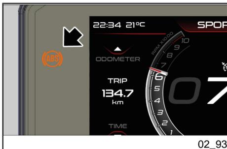
All'avviamento del veicolo, dopo il check iniziale del cruscotto, la spia ABS lampeggia fino a quando non si supera la velocità di 5 km/h (3.1 mph), successivamente la spia si spegnerà.
