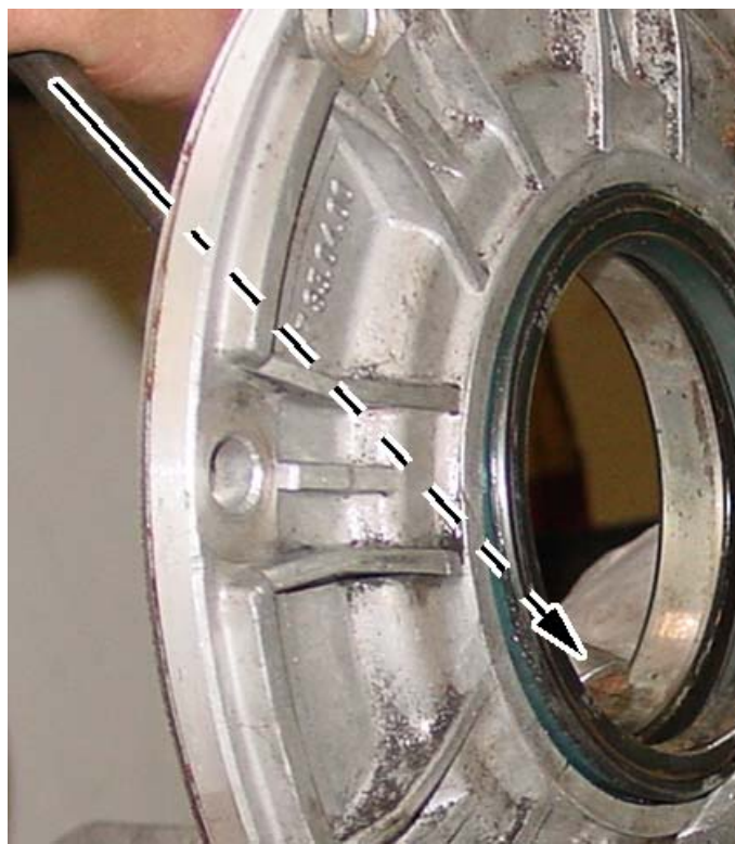
Puis nous l'avons chassé de l'intérieur à l'aide d'un jet.
