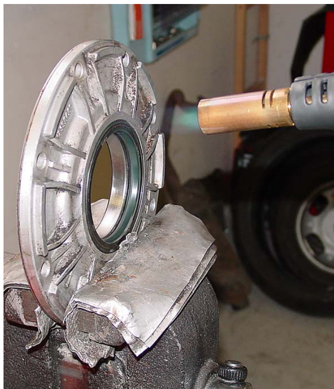
Pour ôter le spi, nous l'avons légèrement chauffé.
