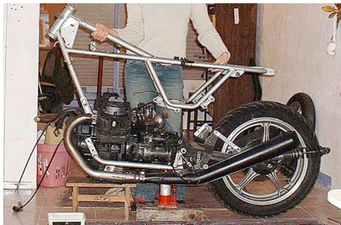
Ôtez les 2 boulons inférieurs de boîte. L'écrou interne est bloqué par des nervures du carter de boîte.
