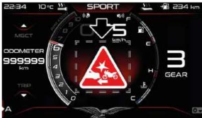
En cas de dysfonctionnement du radar avant, la zone contextuelle du tableau de bord deviendra orange et le message « Front Radar Disabled » apparaîtra avec le triangle d'avertissement à côté.
