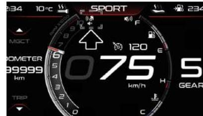
Si elle est activée, cette fonction signale la présence d'obstacles s'approchant sur le côté avant du véhicule, soit par la droite, soit par la gauche, au moyen de signaux sonores et lumineux sur l'écran. En cas d'un objet qui s'approche, avec un risque de collision avant, il y aura deux niveaux d'alerte :
