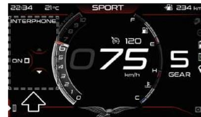
Il sera ensuite possible de contrôler le niveau de volume reproduit en utilisant les boutons MODE UP et MODE DOWN, en appuyant longuement dessus.
