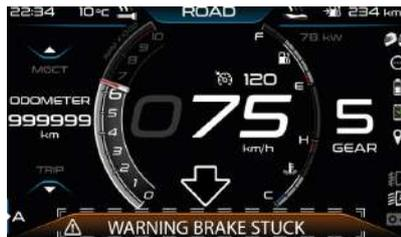
Si la pression est exercée pendant plus de 60 secondes, avec véhicule en mouvement à vitesse égale ou supérieure à 10 km/h (6 mph) :
