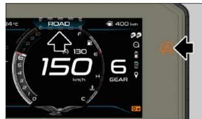
Pour accéder à l'écran de réglage des modes de conduite, sélectionner la page « Riding Mode » dans le « Launcher menu » (pour plus d'informations sur le LAUNCHER MENU, voir la section « Fonctions avancées »).
