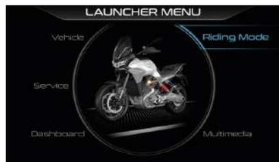
En utilisant le bouton MODE RIGHT, se placer sur le MODE DE CONDUITE à modifier, puis utiliser les boutons MODE UP ou MODE DOWN pour se placer sur l'élément à modifier et modifier le niveau d'intervention à l'aide du bouton MODE RIGHT.
