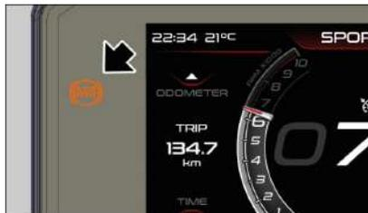
Si le voyant ABS reste allumé fixe, ou continue à clignoter même après le dépassement de la vitesse de 5 km/h (3.1 mph), le système a détecté un mauvais fonctionnement et l'ABS a été désactivé.
