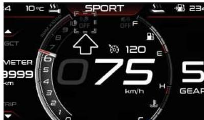
Radar activé : l'icône illustrée sur la figure colorée en blanc sera présente sur le tableau de bord.
