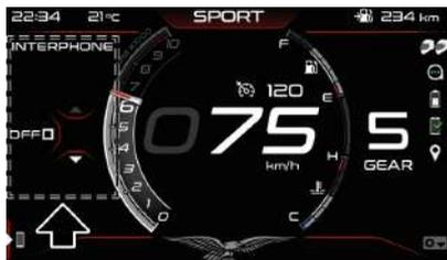
Pour activer la fonction « VOICE CONTROL » qui permet d'utiliser le smartphone en impartissant des commandes vocales via les oreillettes (ex. Siri ou Google Assistant), après l'avoir sélectionnée à l'aide des boutons MODE UP ou MODE DOWN, appuyer brièvement sur le bouton MODE SET.
