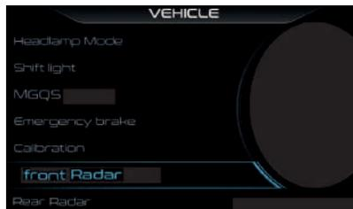
Une fois dans le menu, il est possible de régler l'état du système au moyen de pressions courtes sur le bouton MODE RIGHT, qui fera défiler de manière cyclique les trois états possibles :
