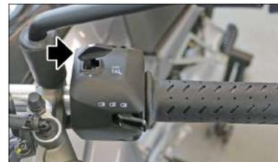
À l'aide des boutons de commande sur le commodo gauche, il est possible de naviguer dans les onglets du système, d'afficher les informations du journal de bord A/B, et en cas de calculateur GMP (Guzzi Multimedia Platform), également les informations téléphoniques, musique et média.
