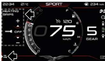
Lorsque le chauffage des poignées est activé, l'icône correspondante s'active sur le tableau de bord, elle montre également le niveau d'intensité du chauffage sélectionné.
