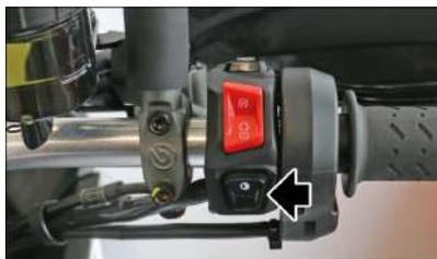
Une fois désactivée, la fenêtre contextuelle deviendra orange, le message « ABS désactivé » apparaîtra et l'icône correspondante s'affichera, indiquant l'absence de contrôle de l'ABS sur les deux roues (uniquement pour le mode de conduite OFF-ROAD).
