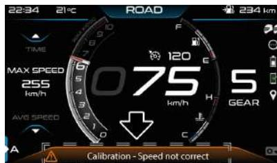
Pour étalonner le système MGCT (Moto Guzzi Control Traction), rouler sur un tronçon de route plat et droit pendant environ 10 secondes, en deuxième vitesse à une allure de 40 +/- 2 km/h (24.85 +/- 1.24 mph), jusqu'à ce que le message « Calibration - Hold speed » (Étalonnage en cours, maintenir la vitesse) s'affiche sur l'écran numérique.
