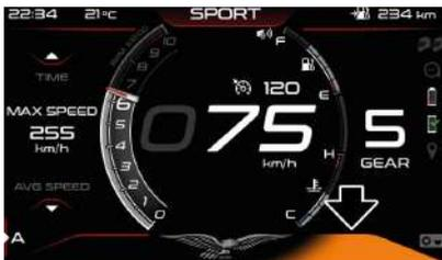
En cas de dysfonctionnement du radar arrière, la zone contextuelle du tableau de bord deviendra orange et le message « Rear Radar Disabled » apparaîtra avec le triangle d'avertissement à côté.
