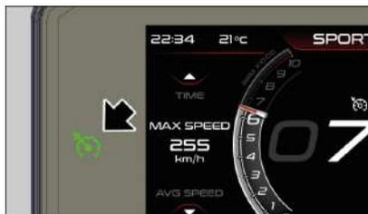
Le pilote peut alors relâcher la poignée d'accélérateur puisque le système sera en mesure de maintenir la vitesse sélectionnée de façon autonome.
