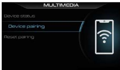
Après avoir activé dans le dispositif à associer la fonction Bluetooth, par une pression courte sur le bouton « MODE RIGHT », en sélectionnant dans le menu multimédia du véhicule la commande « Devices pairing », les dispositifs disponibles pour un appariage seront recherchés.
