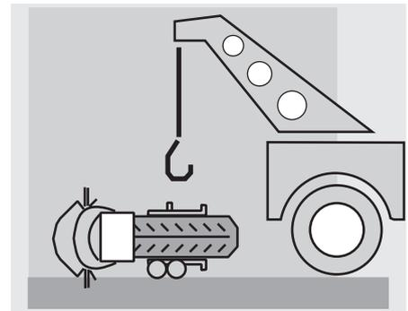
Si le véhicule a été impliqué dans un accident ou bien a subi un choc ou une chute, s'assurer que les leviers de commande, les tubulures, les câbles, le système de freinage et les parties vitales ne sont pas endommagés.
