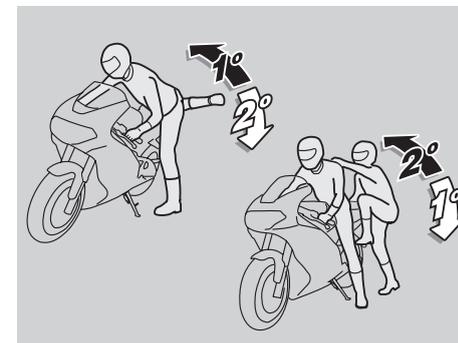
**IMPORTANT** Le pilote est toujours le premier à monter et le dernier à descendre du véhicule ; c'est lui qui doit contrôler l'équilibre et la stabilité durant la phase de montée et de descente du passager.
