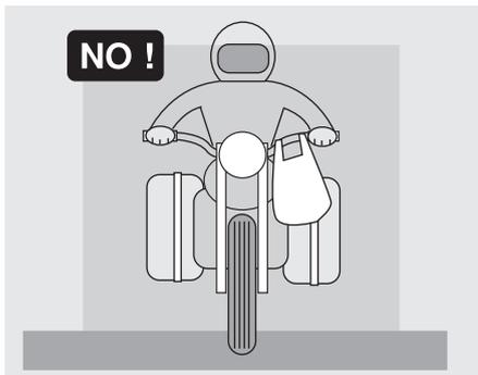
Ne jamais fixer d'objets encombrants, volumineux, lourds et/ou dangereux au guidon, aux garde-boue et aux fourches : cela pourrait ralentir la réponse du véhicule en virage et compromettre inévitablement sa maniabilité.
