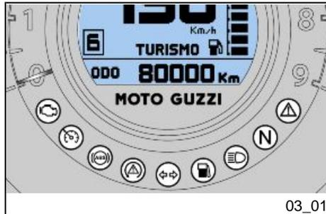
Ce véhicule est conçu pour identifier en temps réel d'éventuelles anomalies de fonctionnement, mémorisées par le boîtier électronique.
