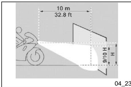
Pour une vérification rapide de la bonne orientation du faisceau lumineux avant :
